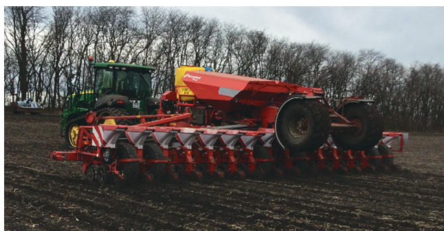
Рис. Сеялка точного высева «Optima TFmaxi» в агрегате с трактором «John Deere 8310RT»
